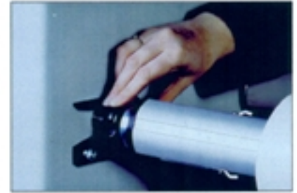
Ausschwenkbarer Rollenhalter mit einfacher Folienspannungseinstellung an der Abwickelachse
