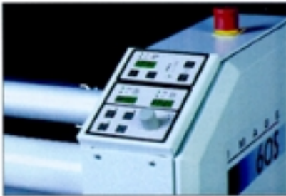
Berührungsfeld-Steuerpult für eine unabhängige Begelung der Einstellungen.
