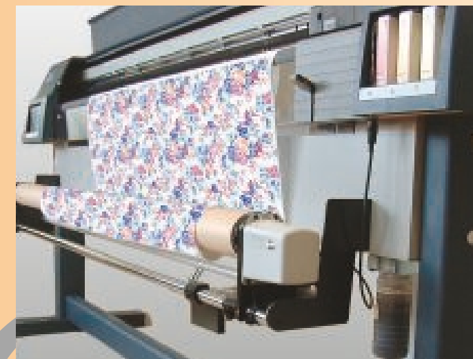
Müheloser Endlosbetrieb durch sensorgesteuerte Aufwickelvorrichtung
